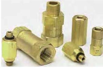
Les clapets anti-retour permettent le passage du fluide dans une direction seulement. Tous ont un corps en laiton usiné permettant un montage en ligne, des joints BUNA-N, et des ressorts acier inoxydable en standard.
